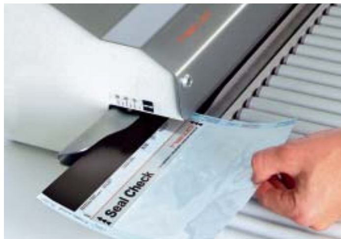
Siegelnahtprüfung mit dem Seal Check: Fehlerhafte Stellen werden auf dem dunklen Indikatorstreifen sichtbar
